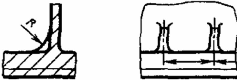
Рис. 31. Изображение усадочных ребер и технологических приливов
